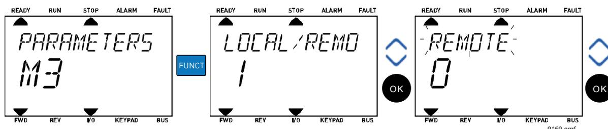
Figura 71. Cambio de las estaciones de control.
