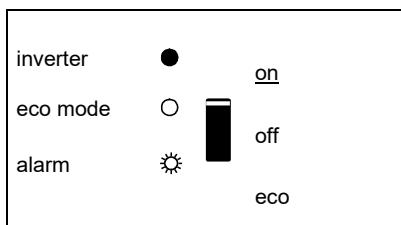
Der Wechselrichter ist eingeschaltet und liefert Strom an die Verbraucher.
