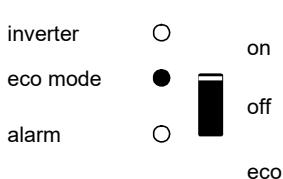
Der Wechselrichter arbeitet im „eco mode“
