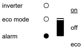
Der Wechselrichter ist ausgeschaltet.
