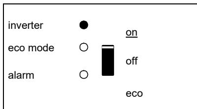
Batterij bedrijf. De omvormer staat aan en levert vermogen aan de belasting.
