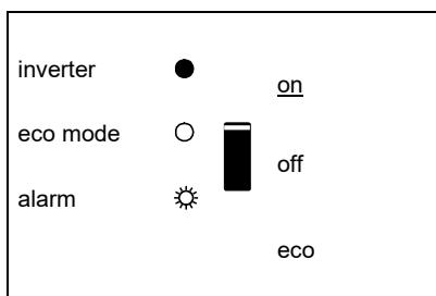
De omvormer is ingeschakeld en levert vermogen aan de belasting.
