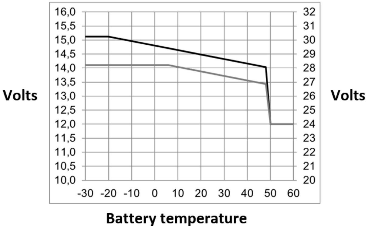
Las tensiones predeterminadas de salida de flotación y absorción son a 25 °C. Tras la tensión de flotación, viene la tensión de flotación reducida, y tras la tensión de absorción viene la tensión de absorción aumentada. En modo de ajuste la compensación de temperatura no se aplica.
