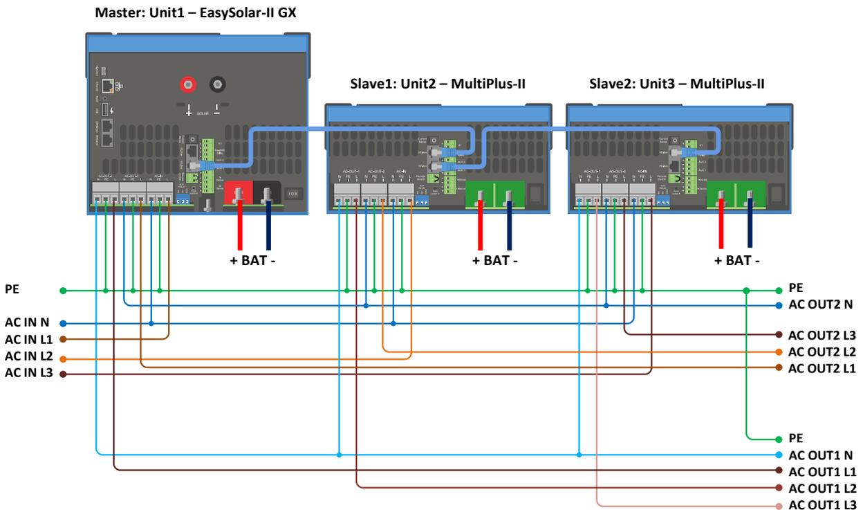
Para sistemas trifásicos se requieren condiciones adicionales, puede leer documentación específica aquí - [https://www.victronenergy.com/live/ve.bus:manual\\_parallel\\_and\\_three\\_phase\\_systems](https://www.victronenergy.com/live/ve.bus:manual_parallel_and_three_phase_systems)
