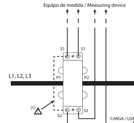
(1) Una vez cableado el secundario del transformador (S1 y S2) al equipo de medida, eliminar el puente realizado entre los secundarios de corriente. / Once the secondary of the transformer (S1 and S2) is wired to the measuring device, disconnect the jumper installed between the secondary current.
