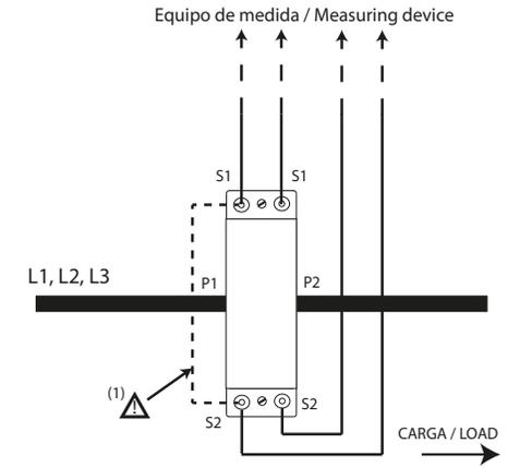
(1) Una vez cableado el secundario del transformador (S1 y S2) al equipo de medida, eliminar el puente realizado entre los secundarios de tensión. / Once the secondary of the transformer (S1 and S2) is wired to the measuring device, disconnect the jumper installed between the secondary current.
