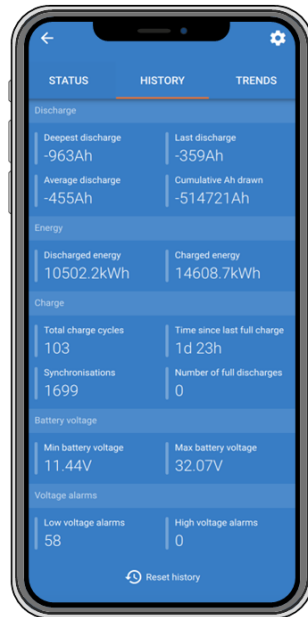
Pantalla de historial del monitor de baterías de la aplicación VictronConnect.
