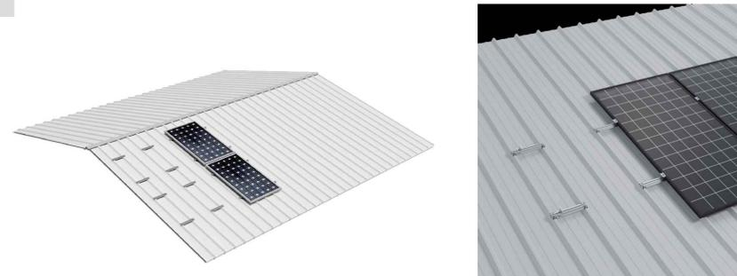
El perfil se fija a la chapa mediante 4 tornillos S42.1 (2 a cada lado)
