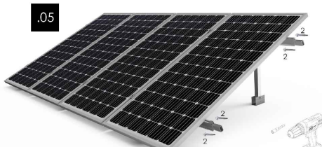
Kit 1 - Fijar las uniones del perfil guía inferior mediante los tornillos de fijación (2 a cada lado de la unión) Repetir en perfil guía superior.
