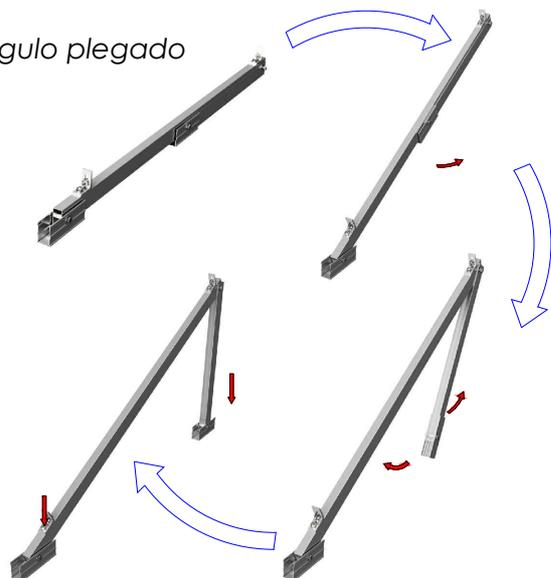
Apriete de las uniones y anclaje al suelo mediante tornillo de hasta M10.
