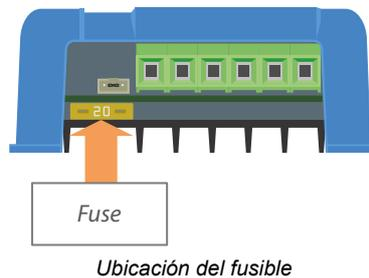
Retire el fusible para comprobar su continuidad. Si el fusible está averiado, sustitúyalo por uno nuevo. Pero, antes de colocar el fusible nuevo, compruebe la polaridad de la batería y corríjala si no es correcta.
