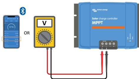
2. Use un multímetro para medir la tensión en los terminales de la batería.
