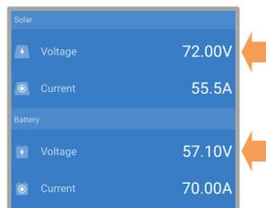
2. En caso de que no se pueda realizar el paso anterior, mida la tensión de la batería y la FV en los terminales del cargador solar con un multímetro.
