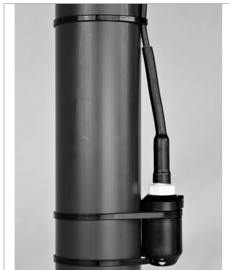
Figura 48: Fijación de la sonda del pozo
