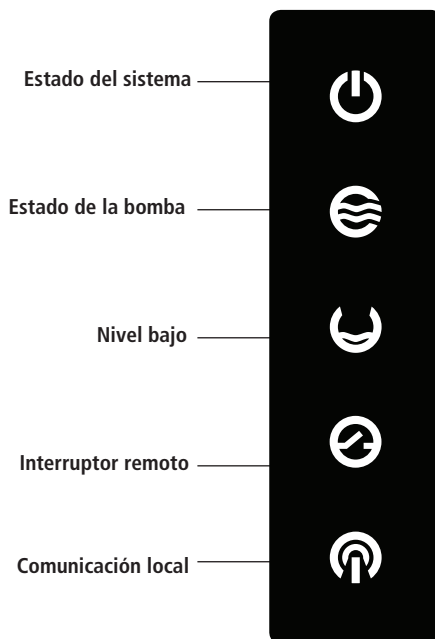
Figura 66: Indicadores LED frontales del controlador PSk2.
